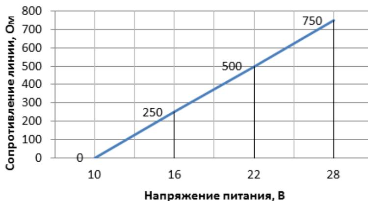
**Рисунок 2.3 – Нагрузочная характеристика токового выхода (по вертикали - максимально допустимое сопротивление линии)**
